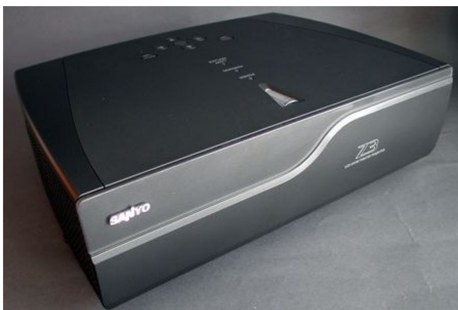
Projektor mit geschlossener Schutzklappe
